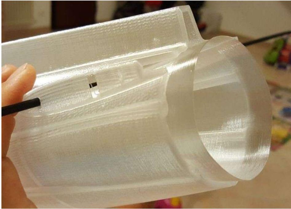
Tubo venturi inserito all'interno della fusoliera
