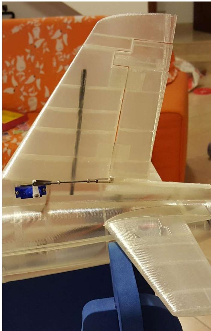
Tubo in carbonio diametro 4 mm anche per la sezione del timone.
