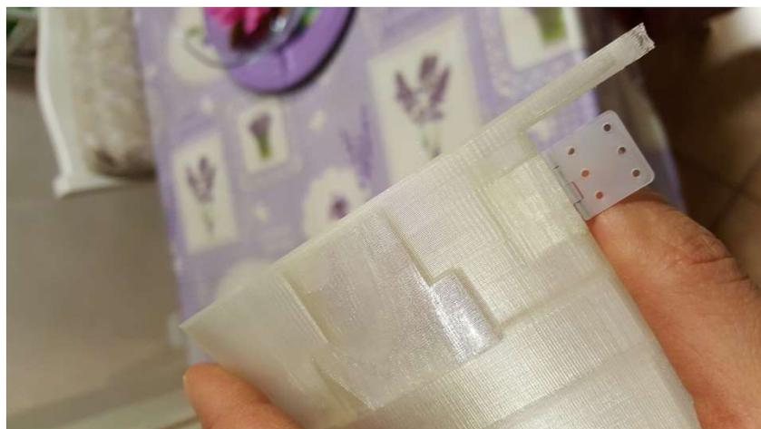
Dettaglio cerniera per pianetto foto sopra e dettaglio cerniera ala foto sotto.
