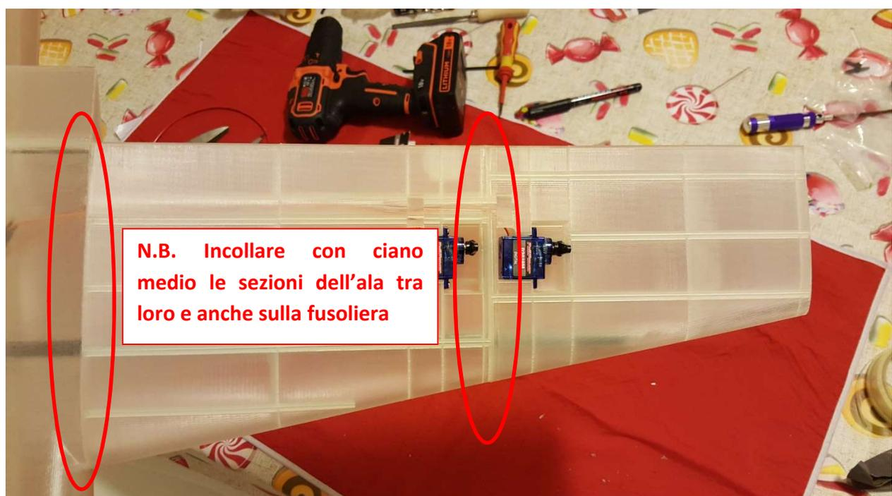
Come riportato nella foto precedente, è molto importante incollare tutte le sezioni delle ali tra loro e anche sulla superficie d'appoggio della sezione centrale della fusoliera, questo garantisce il giusto funzionamento di tutta la struttura dell'ala. Tutti i cavi e future sostituzioni di servi/macchinette carrello sono garantite dal passaggio interno nell'ala dei cavi, quindi non c'è bisogno di smontare l'ala.
