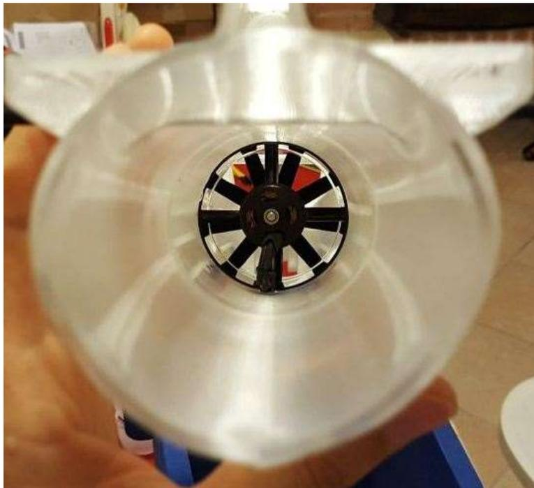
Dettaglio venturi scarico posteriore ( esempio con ventola vemotec )
