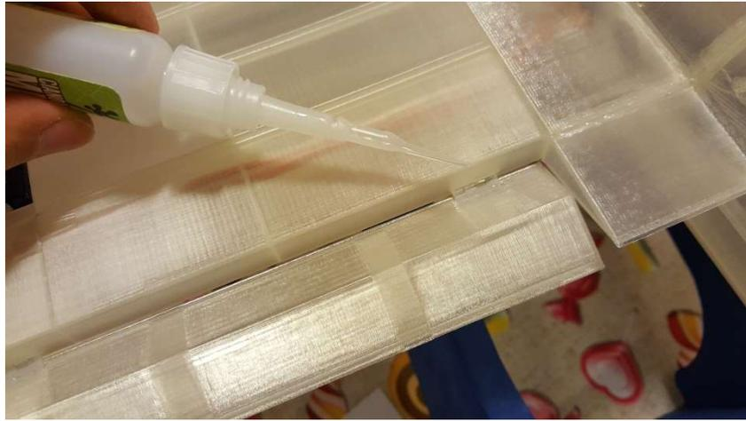
Si possono rinforzare gli incollaggi delle cerniere anche dalla parte inferiore delle parti mobili
