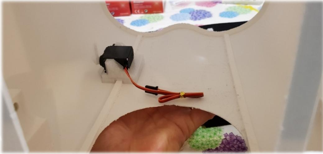
Particolare dell'installazione del servo all'interno della fusoliera
