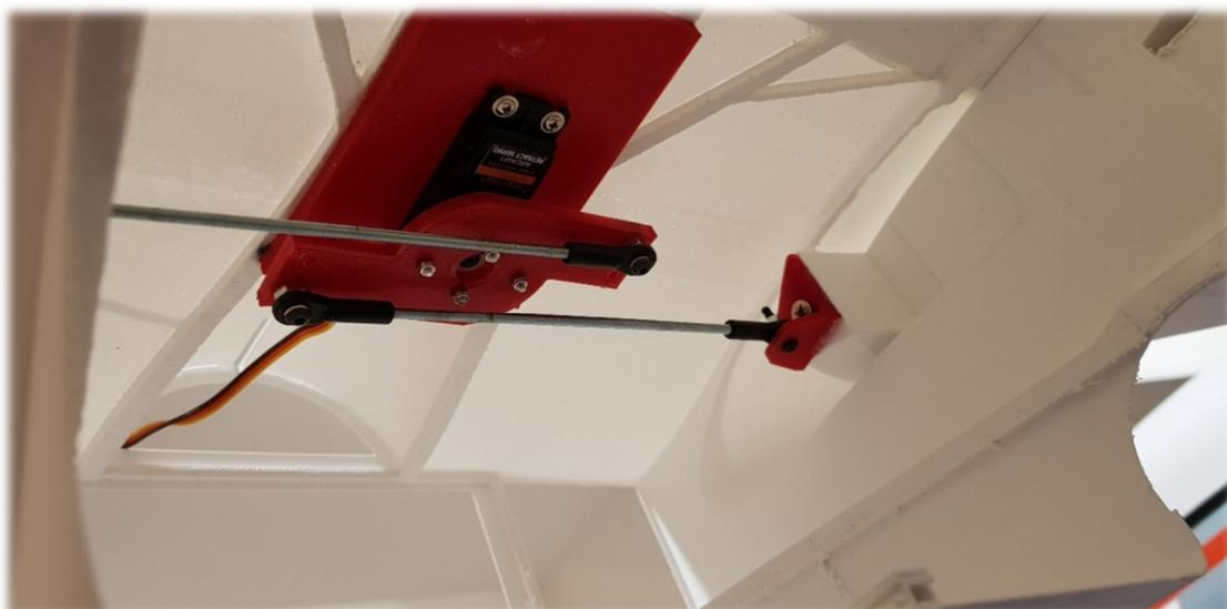
Ulteriori dettagli sul sistema di rotazione
