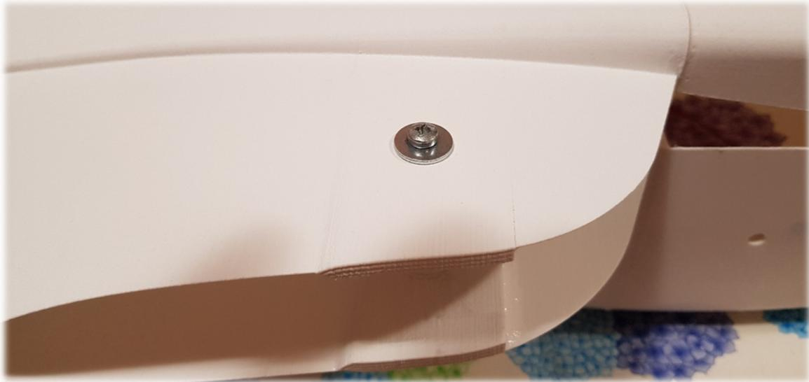
Utilizzare le rondelle per uniformare la pressione di spinta della vite
