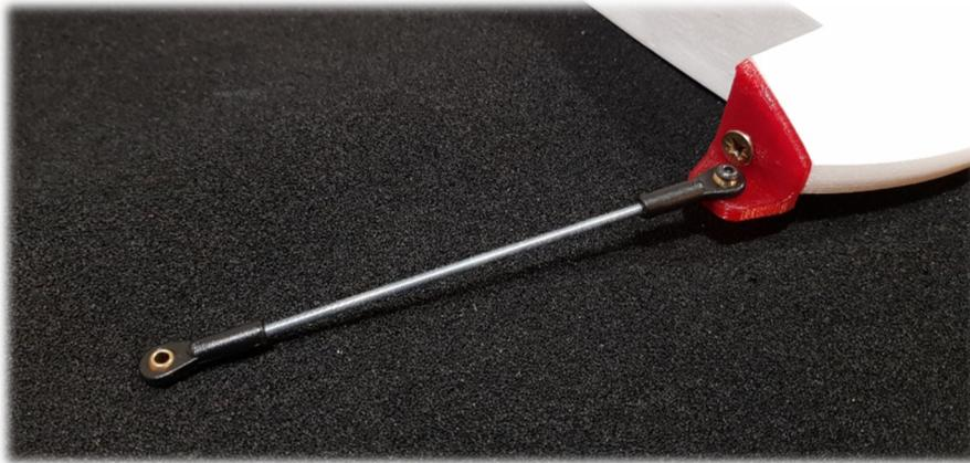
Preparare il tubo in carbonio del diametro di 12mm come da misura
