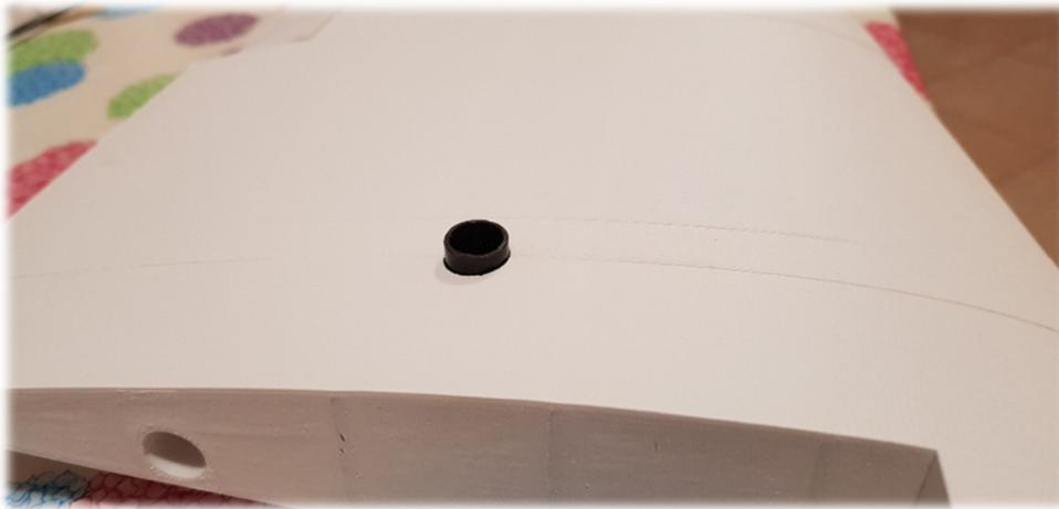
Forare la fusoliera per inserire la vite M4 e inserire il tubo in carbonio da 12 mm di diametro precedentemente inserito nell'ala all'interno della fusoliera, come foto seguente:
