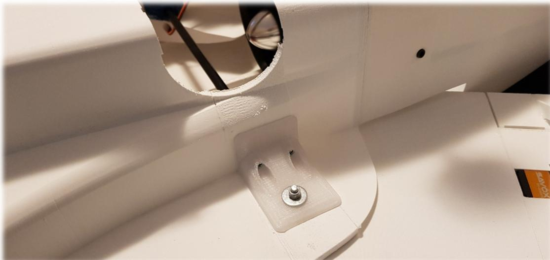
Incollare con ciano medio la base del supporto del servo allineando il collegamento come mostrato nella foto
